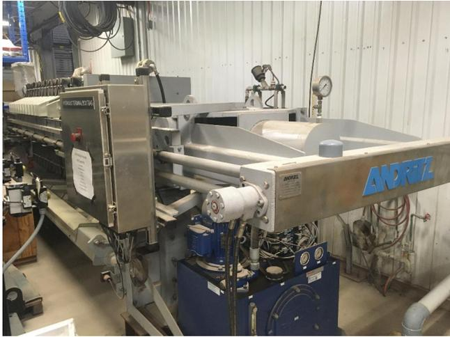
Sistema de filtro prensa de barra lateral Andritz de 1000 mm
