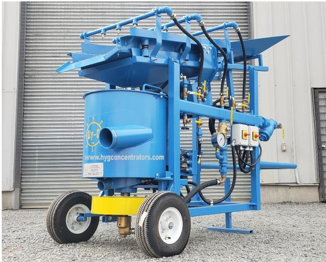
La planta concentradora centrífuga de prueba Hy-G P12T cuenta con un clasificador de pantalla de lavado vibratorio incorporado. Los geólogos y mineros de placer suelen utilizar este modelo semiportátil para pruebas de muestras de campo, en plantas de producción pequeñas o en salas de oro para limpiar concentrados de Hy-G de tamaño completo de producción u otros equipos de recuperación de oro fino.
