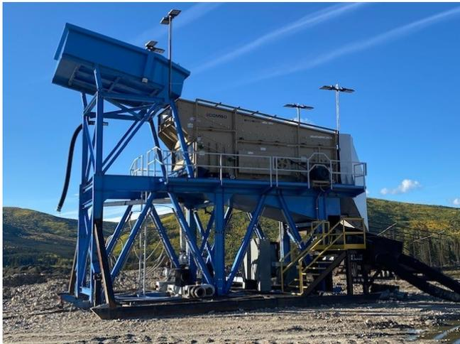
Planta de lavado de oro de 500 TPH con Cubierta de Cribado KPI-JCI y Cajas de Esclusas
