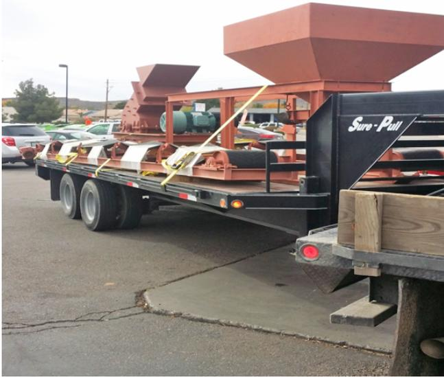
Paquete completo de trituración que consiste en un tolva, alimentador de mineral fino de 2 tph, transportador de 16in x 18ft y un molino de martillo de 24in x 16in. Incluye un remolque Sure-Pull Gooseneck de 25 ft.
