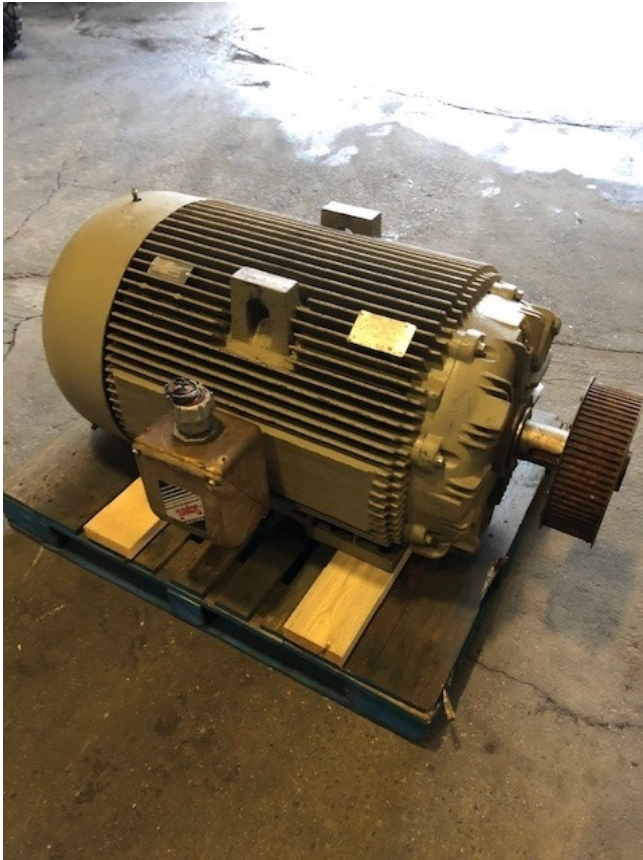
Motor eléctrico de 200 hp
