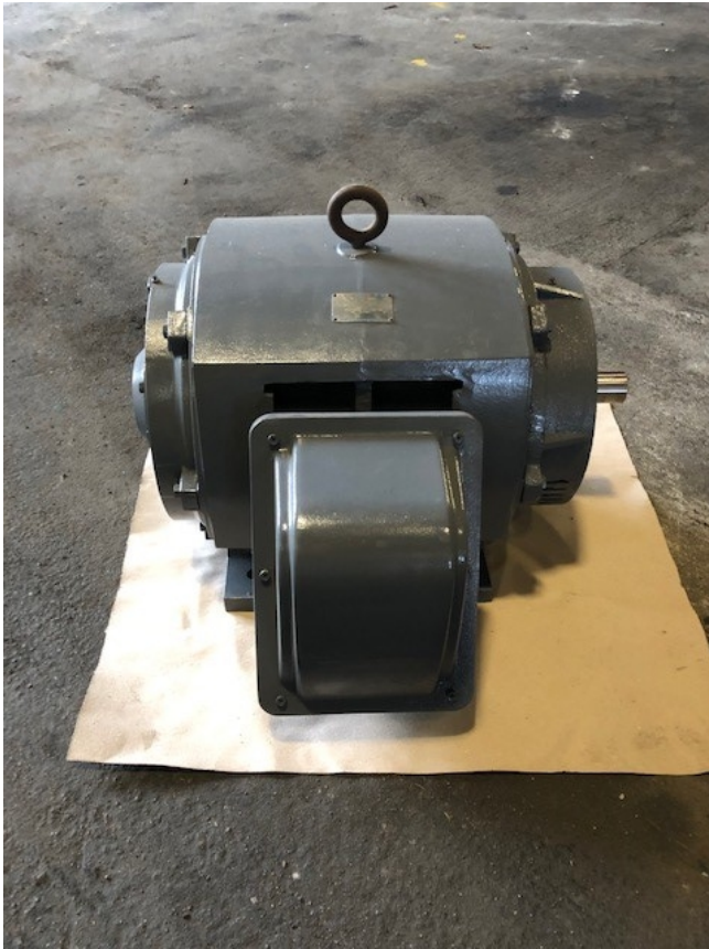
Motor eléctrico Teco Optim de 125 hp
