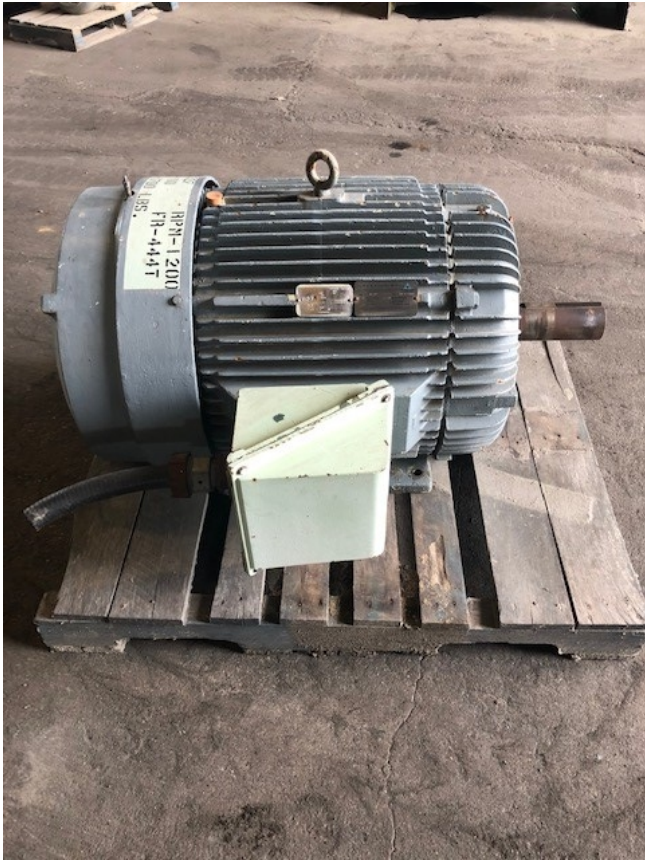
Motor eléctrico Reliance de 100 hp
