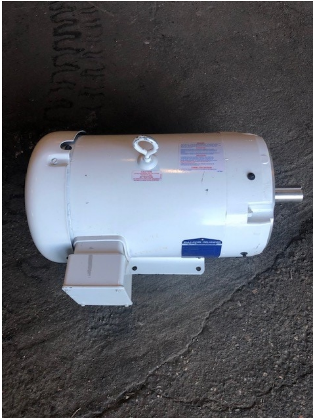
Motor eléctrico Baldor Reliance de 7.5hp
