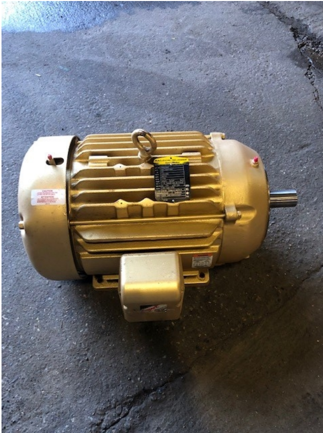
Motor eléctrico Baldor de 20 hp
