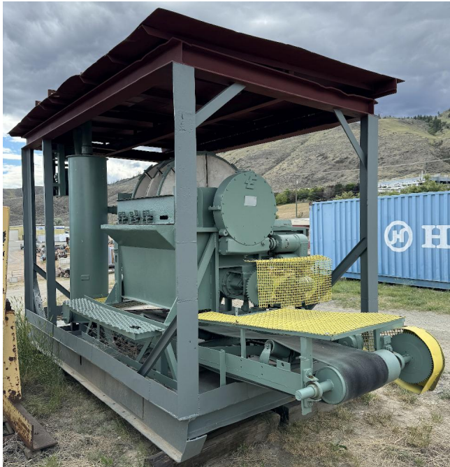
Filtro de disco montado en módulo de operación
