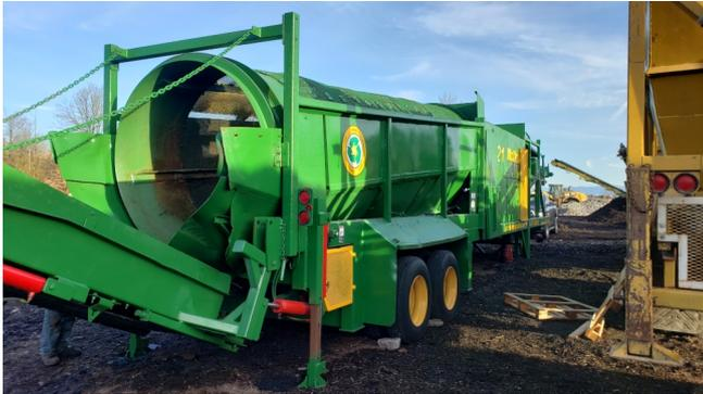
El trommel cribador 621 es una máquina confiable y probada en construcción y demolición, tierra vegetal, compost, reciclaje de desechos y muchas otras aplicaciones de pantallas grandes. Impulsado por un motor de 174 HP adecuado para grandes aplicaciones de servicio pesado donde las tasas de producción pueden alcanzar más de 200 TPH en tierra y material pegajoso o 300 + TPH en arena y grava.
