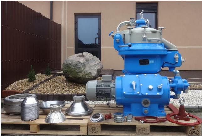
WSK Alfa Laval MAPX 207 Separator
