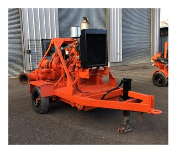
Godwin CD225M Dri-Prime Portable Diesel Pump
