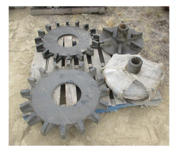
Flotation Cell Impellers
