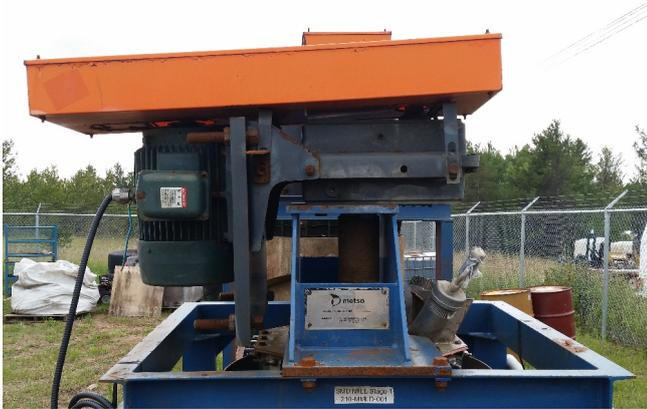
Reductor montado en eje con motor
