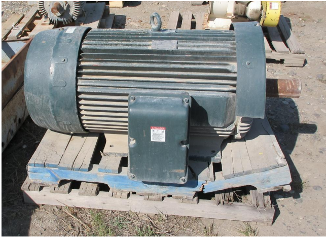
Motor eléctrico Toshiba de 200 hp
