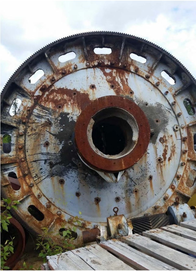
Molino de Bola Allis Chalmers de 8ft dia x 10ft
